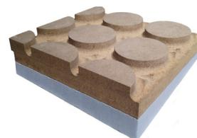
Pannello in polistirene estruso densità 15÷35 kg/m<sup>3</sup> | Conduttività termica dichiarata  $\lambda_D$ [W/(m\*k)] 0,026÷0,036 | Calore specifico c 1.450 J/kg K
