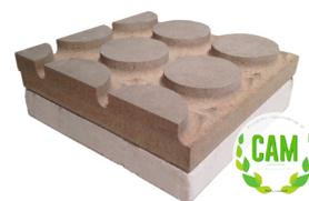
Pannello in polistirene espanso densità 15÷35 kg/m<sup>3</sup> | Conduttività termica dichiarata  $\lambda_D$ [W/(m\*k)] 0,026÷0,036 | Calore specifico c 1.200 J/kg K
