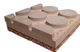
Pannello in sughero biondo densità 150÷160 kg/m<sup>3</sup> | Conduttività termica dichiarata  $\lambda_p$ [W/(m\*k)] 0,041 | Calore specifico c 1.674 J/kg K
